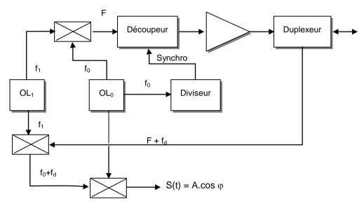
Le radar émet des impulsions à la fréquence F somme des fréquences des deux oscillateurs  $f_0$  et  $f_1$ . Ce signal revient, après réflexion sur un écho fixe, à un instant  $t_0$  entaché d'une erreur  $\epsilon$ , due au jitter de l'émetteur.
