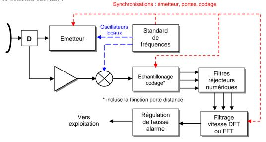
Dans les cas les plus simplifiés, on se contente d'un simple filtre VCM avant filtrage vitesse selon le schéma ci-après :
