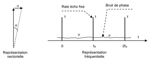
Ce bruit de phase se répartit en moyenne uniformément sur toutes les fréquences, et dans des conditions de fonctionnement données (durée d'impulsion  $\tau$ , période de répétition  $T_R$ , retard  $t_k$ ), la répartition spectrale du signal reçu sera (voir ci dessus) la somme des raies dues aux échos fixes et du bruit de phase.
