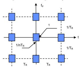
Cette configuration de diagramme d'ambiguïté est directement exploitée dans le radar pulse doppler, par le traitement cohérent du train d'impulsions. Celui ci peut donc être utilisé comme VCM (Nous aurons d'ailleurs l'occasion d'y revenir).
