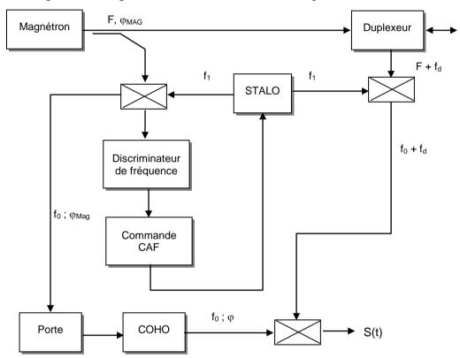
Il convient alors de recopier la fréquence et la phase du signal émis, pour ce faire : L'oscillateur local contrôlé par le CAF ou STALO mémorise la fréquence émise. L'oscillateur cohérent ou COHO, mémorise la phase du signal émis. Les signaux mis en présence sont :
