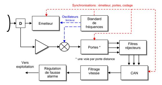
Chaque porte est ouverte pendant une fraction de la récurrence proche de la durée des impulsions émises. Si une cible se trouve dans la zone de distance ainsi sélectionnée, elle donne naissance à un train d'impulsions périodiques de fréquence  $f_0 + f_d$ .
